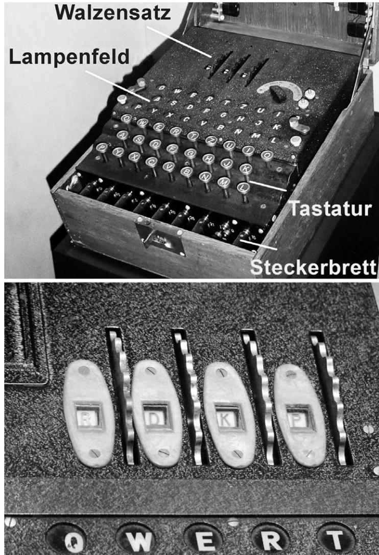
*Enigma, Gesamtansicht und Detailansicht der Stellräder einer Vierwalzen-Enigma. Quelle: [https://de.wikipedia.org/wiki/Enigma\\_\(Maschine\)](https://de.wikipedia.org/wiki/Enigma_(Maschine))*
